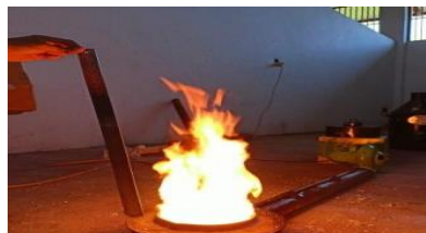
Gambar 6. Blower untuk menstabilkan api yang ada di Burner
