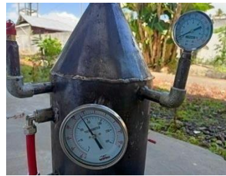
Gambar 8. Air di didihkan maka jarum dari thermometer dan manometer akan bergerak
