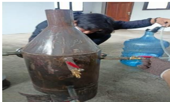
Gambar 2. air ke dalam Prototype Boiler Fire Tube sebanyak 6 liter
