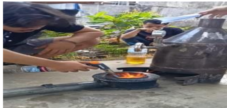
Gambar 5. Kertas yang sudah di lumuri bahan bakar ke dalam burner dan nyalakan api.
