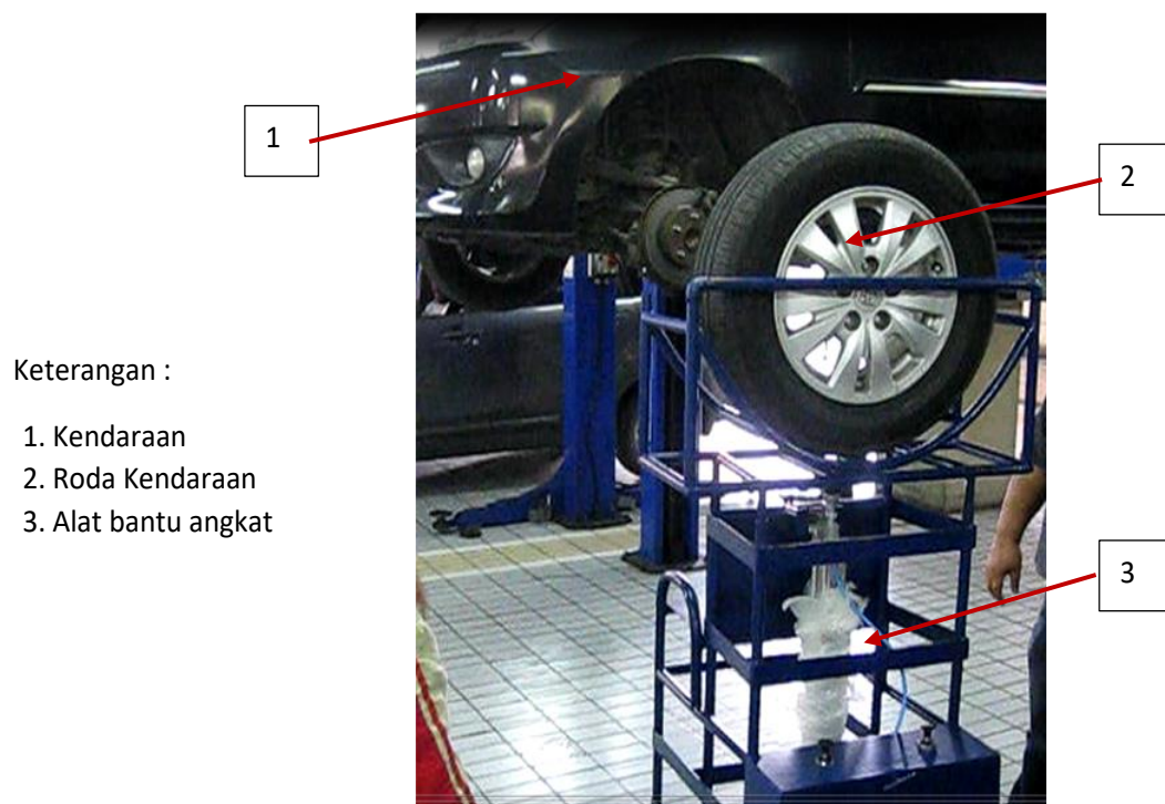
Gambar 3. Alat Bantu Angkat pneumatik untuk pasang – lepas roda kendaraan di industri
