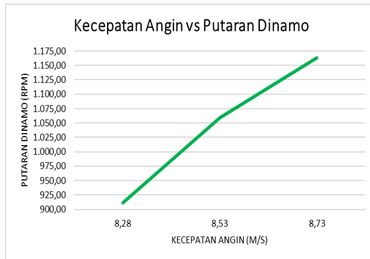
Gambar 18. Grafik Rata-rata Pengujian Kecepatan Angin vs Putaran Dinamo
