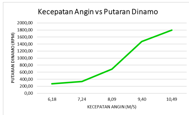
Gambar 9. Grafik Kecepatan Angin vs Putaran Dinamo pada Pengujian I
