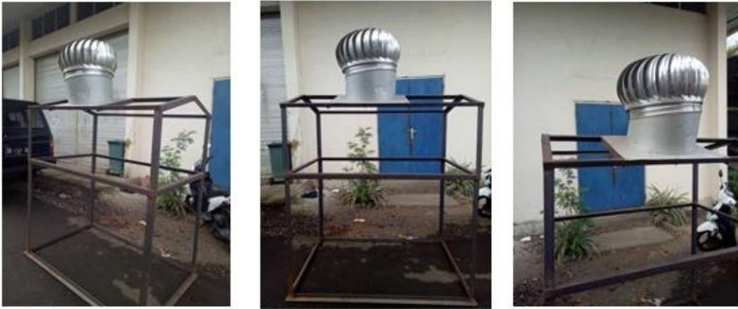
Gambar 5. Rangka Penyangga Turbin Ventilator
