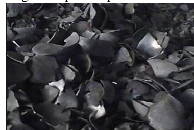
Gambar 5. Arang tempurung hasil pembakaran pada pipa lorong api dengan pembakaran pirolisis
