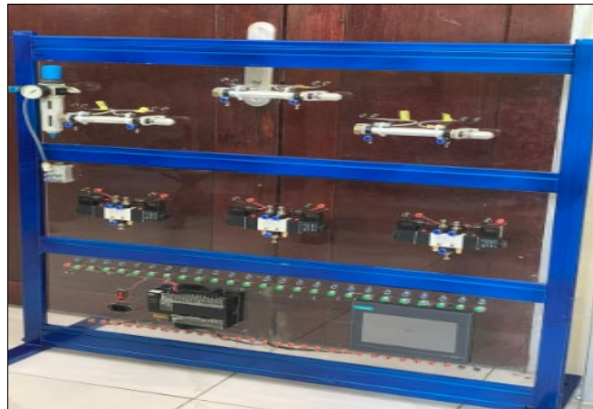
Gambar 9. Pemasangan Air Service Unit Tombol Power PLC dan Soket Power Supply
