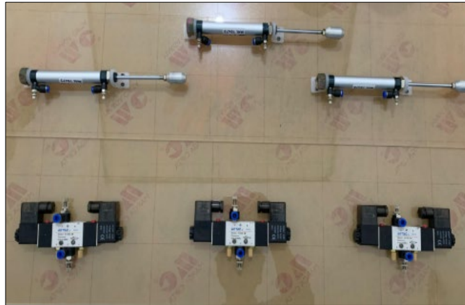
Gambar 8. Pemasangan Silinder dan Solenoid Pada Akrilik
