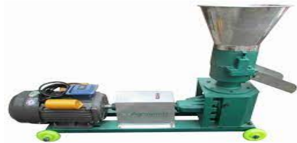
Gambar 3. Mesin Pellet Tipe Vertikal Menggunakan Motor Listrik (Sumber https://images.app.goo.gl/2C8GyZsGHvhDntix8 )
