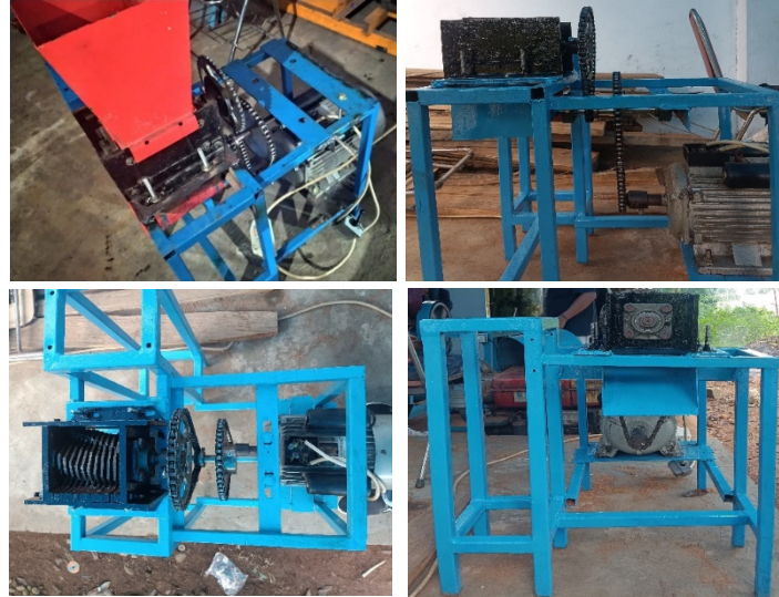
Gambar 6. Mesin Penghancur Kaca Hasil Rancang Bangun
