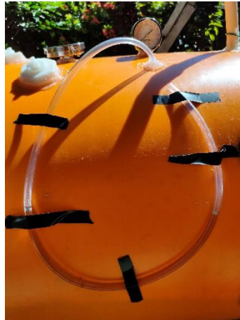
Gambar 2. Manometer U terbuka menggunakan fluida air
