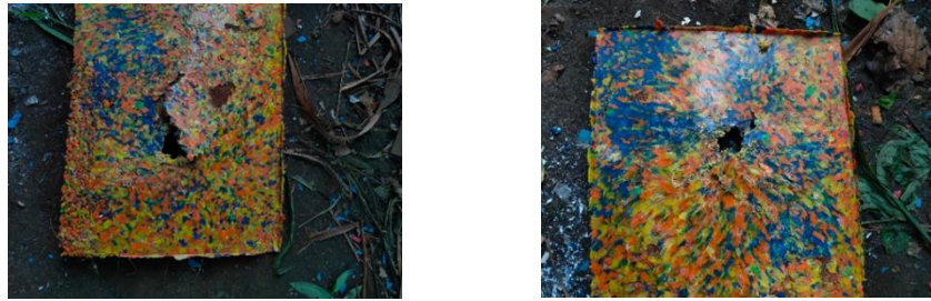
Gambar 4. Hasil cetakan material komposit plastik dan sabut kelapa Temperatur pemanasan maksimum 140 °C dan pelepasan cetakan pada 90 °C.
