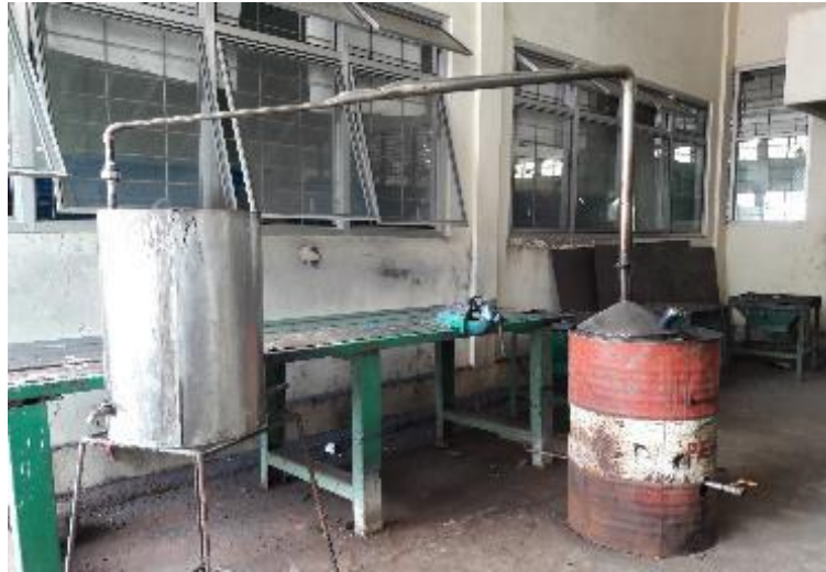
Gambar 2. Foto sistem distilasi pemurnian asap cair yang dibuat
